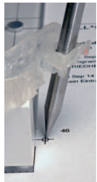
Abb. 8 Spezielle Führungsstifte ermöglichen die Kontrolle bei der manuellen Einstellung des Positionierers, ob Führungshilfen nicht den Werten entsprechend eingepolymerisiert wurden.
